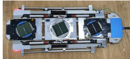
図2 発電機検査ロボット
