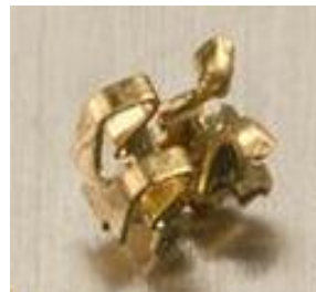
超小型電源端子: C1720-H t=0.12 要求精度 0.003
