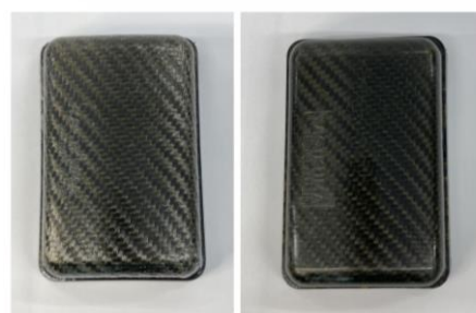
左: 通常成形 右: H&C 成形 写真: ハイブリッド成形+H&C 成形
