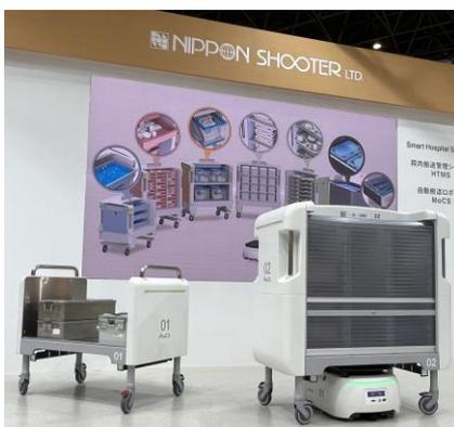
写真は村田機械様と日本シューター様が協働で開発された病院での搬送システム(MoCS)でボディ全体が YaWaRaKa ロボ D で作られています。クッション性と接触したら検知してロボットを停止できる安全なロボットとしてご使用頂いています。デザイン性がとてもよく「グッドデザイン賞2022」も受賞されました。
