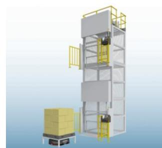
**HART500 専用オートレーターとの連携により階層間を結ぶ立体的な自動搬送ラインの構築が可能
