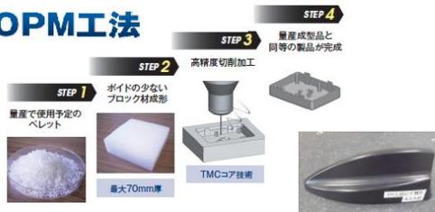
アンテナの電波特性、LED 導光レンズなどの発光性の事前検証が可能
