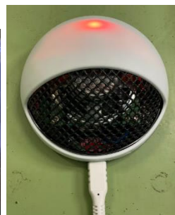
Raspberry Piによる無線CO2 測定・警告 システム(表示部及びセンサユニット)
