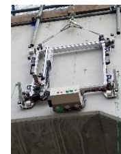
橋脚壁面墨出しロ ボット
