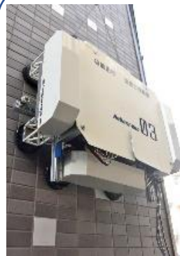
吸着走行壁面診断 ロボット
