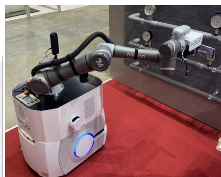
HSR Inspection による点検作業
