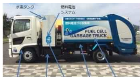
走行用モーター減速機 水素充填口 油圧ポンプ ゴミ収集機構 リチウムイオン電池 燃料電池を使った回収車の導入が期待されます
