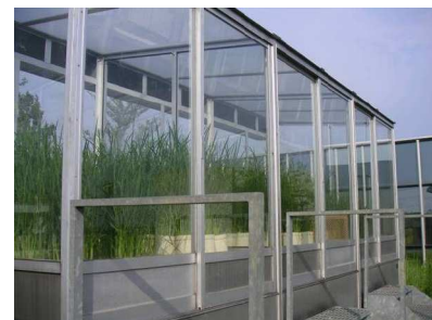
写真4. オゾン濃度の制御可能な温室(埼玉県環境科学国際センター)
