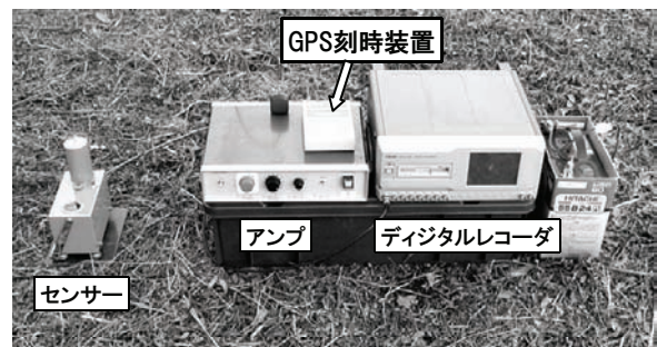
図11 微動の独立観測システム
