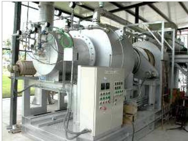
図10 上海交通大学に設置した中温試験焼成設備
