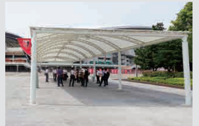
▲南広場の遮熱性舗装と大型日よけテント
