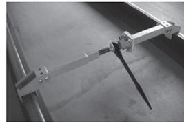
レールの幅(=軌間)を整正するための道具。ラチェット式になっており、押し引きにより軌間を整正します。
