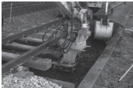
碎石を交換するための機械。アームを枕木の下に配置し、その外周を回転する「チップ」によって碎石を掻き出します。
