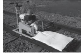
レールを交換する際に使う機械で、新しいレールの被膜や錆を短時間で研磨します。
