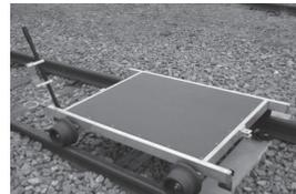
ブレーキ棒を押す(ブレーキを解除すること)で線路上を走行できる荷物の運搬車です。人力で容易に載線や離線ができます。
