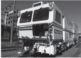
線路の周囲に敷き詰められた碎石を突き固め、レールのゆがみを是正するための保守用車です。
