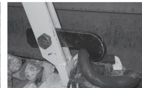
枕木とレールを固定するクリップの締結、解除に用いる道具。テコの原理を利用しており、軽い力で楽に作業が出来ます。
