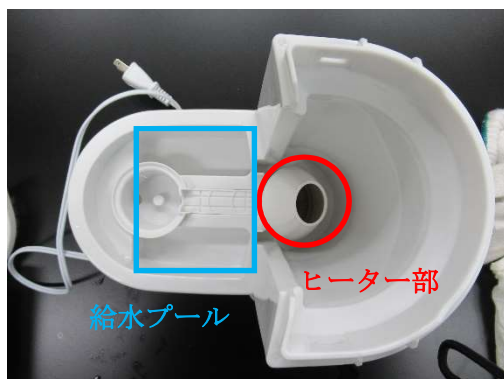
写真 5 加湿器 1 内部構造
