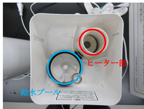
写真 6 加湿器 2 内部構造
