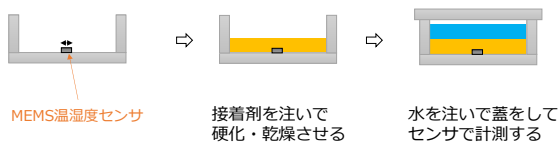
図2 測定セルの概略図
