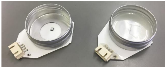
図1 水分拡散係数測定セル (左) および測定セルに接着剤を注いだ様子 (右)
