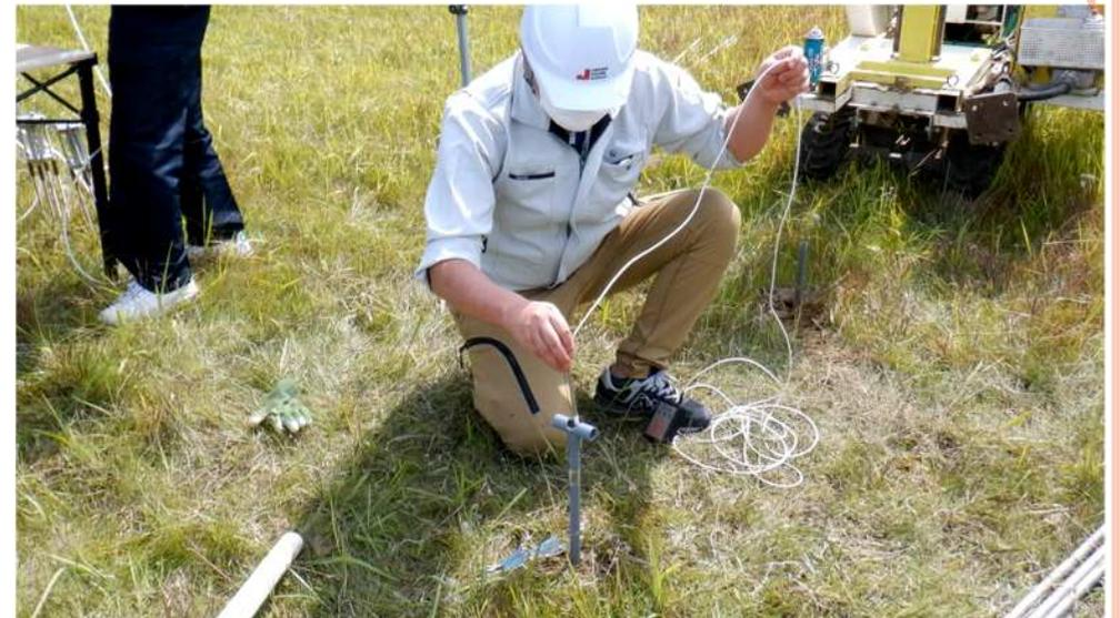
(6)SWS試験孔(調査した孔か別孔)の所定の深度(液状化検討対象深度)で土の試料採取
