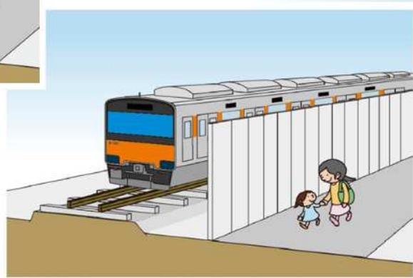
工事区間には、工事中の騒音の低減を図るために、工事区域との境界付近に高さ約3mの仮囲いを設置いたします。
