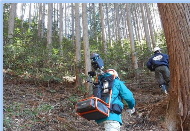
地上レーザによる計測
