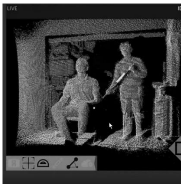
図2 ソフトウェアにより、隠れた身体ランド マークを推定している様子
