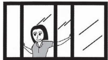
枠とガラス戸の間にゆとりがあるため、建物がゆがんでもガラスに力が加わりません。
