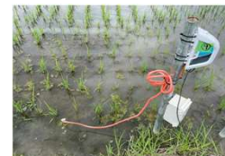
水位・水温・ 土壌温度の計測
