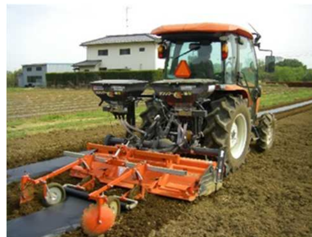
写真1 直進アシスト付きトラクタによるマルチ張り作業
