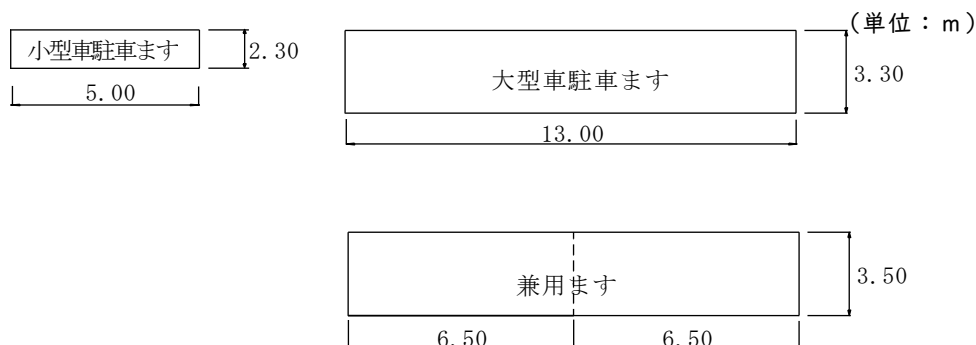
図2-16 大型車、小型車の駐車ます寸法
