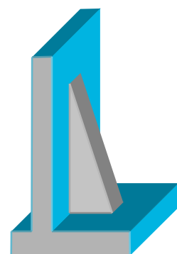
控え壁式擁壁
