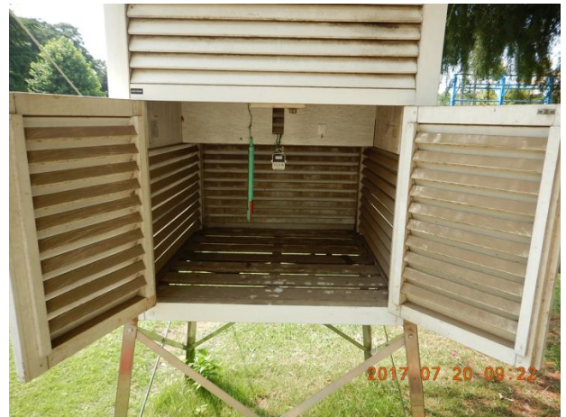
図 5 小学校の百葉箱とデータロガーの設置状況
