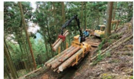
高性能林業機械による木材の運搬
