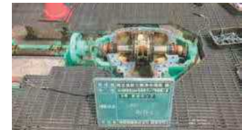
ポンプの分解整備状況
