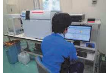
誘導結合プラズマ質量分析計 (金属類の測定)
