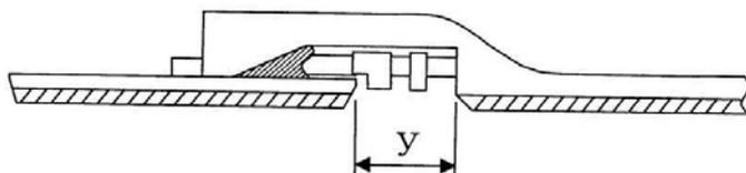
別表4 管水路（強化プラスチック複合管）ジョイント間隔規格値
