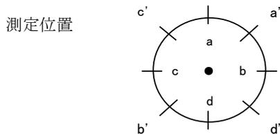
(参考) ジョイント間隔測定位置を以下に示す。
