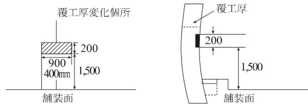
図 7-6-1 覆工厚変化箇所の刻示標準図
