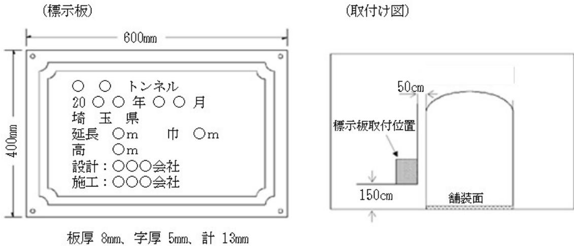
図 7-6-2 標示板の設置イメージ図
