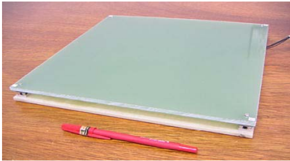
図 2. 試作したセンサ部位 (300mm×300mm)
