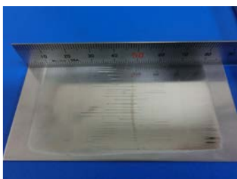
図5 研磨面（電極ヘッド移動：0.1mm/sec）
