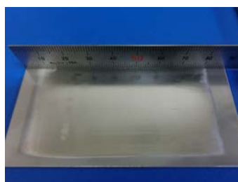
図6 研磨面（電極ヘッド移動：0.5mm/sec）
