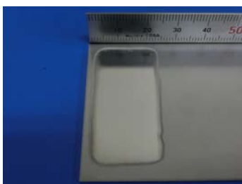
図4 研磨面（電極ヘッド移動無し）
