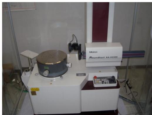
図1 ミットヨ製 真円度測定機 RA-H5100AH
