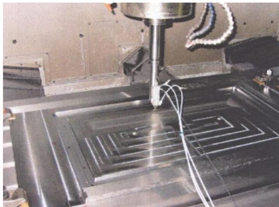
図1 機上測定器によるオンライン計測
