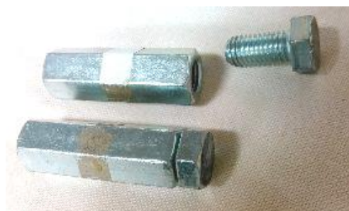
※ 60mm φ12mmの長ボルトで作った打ち込み器。
