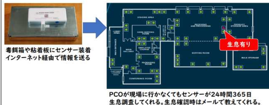
ネズミ遠隔監視システム（米国）
