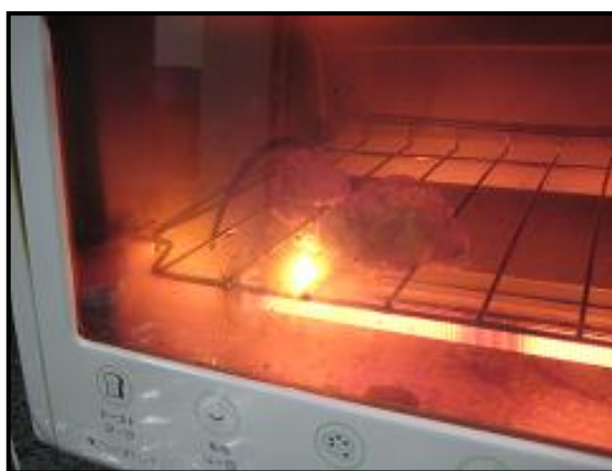
写真5 油がヒーターに垂れて発火した様子
