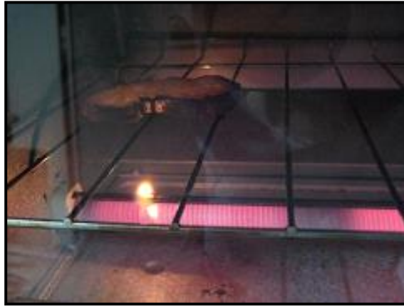
写真6 フランスパンに塗ったバターが ヒーターに垂れて発火した様子
