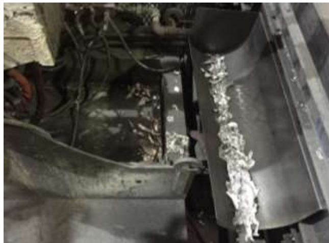
レードルからのドロス（酸化物）を取るボックス
