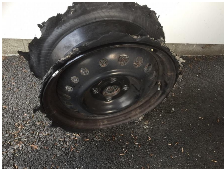
実際にバーストしたタイヤ。ほぼゴム部分がない状態です。
