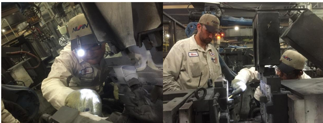
型についたアルミニウムを剥がす作業
