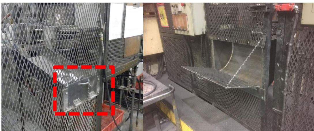
左：既存のシュートドア 右：新しく作成したシュートドア
