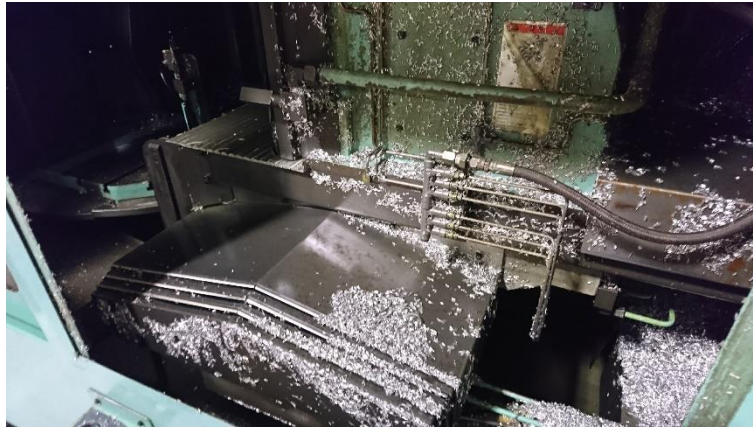
切削後、機械の中に溜まり続けるバリ
