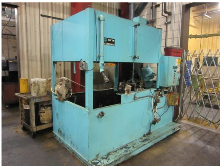
クーラントをリサイクルするための装置
