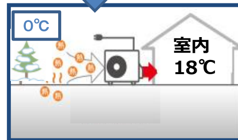
空気熱ヒートポンプの暖房イメージ (0°Cの空気から熱を集める)
