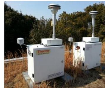
図 1 PM<sub>2.5</sub> 採取装置
