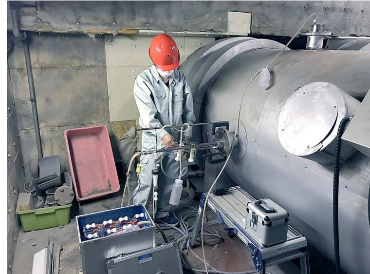
写真6-3 排出ガス中のダイオキシン類濃度の測定
