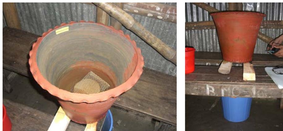
写真5 バングラデシュに設置したヒ素除去装置
