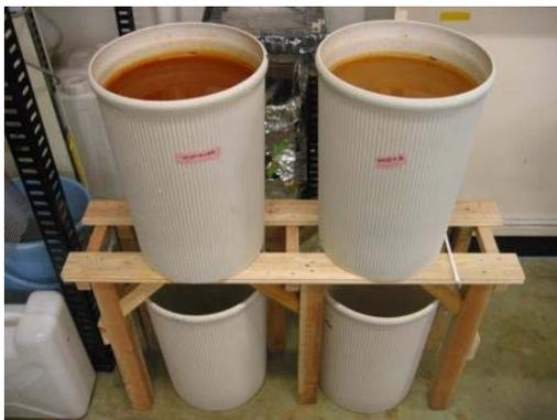
写真4 作製したヒ素除去装置
