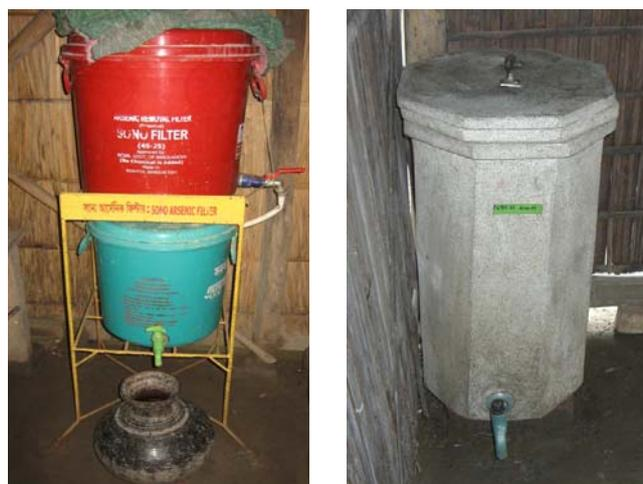
写真2 既存のヒ素除去装置（左）とセラミック式ろ過装置（右）
