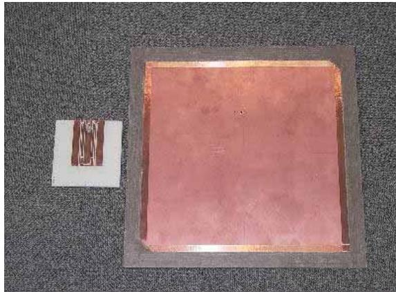
図2 外観(左:送信アンテナ 右:受信アンテナ)
