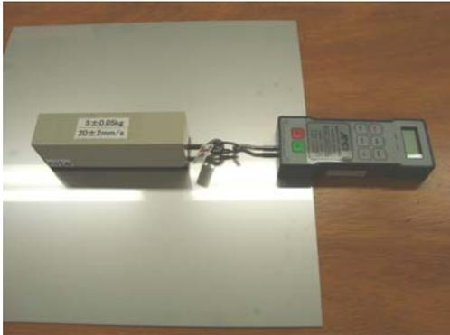
図4 最大静止摩擦力の測定
